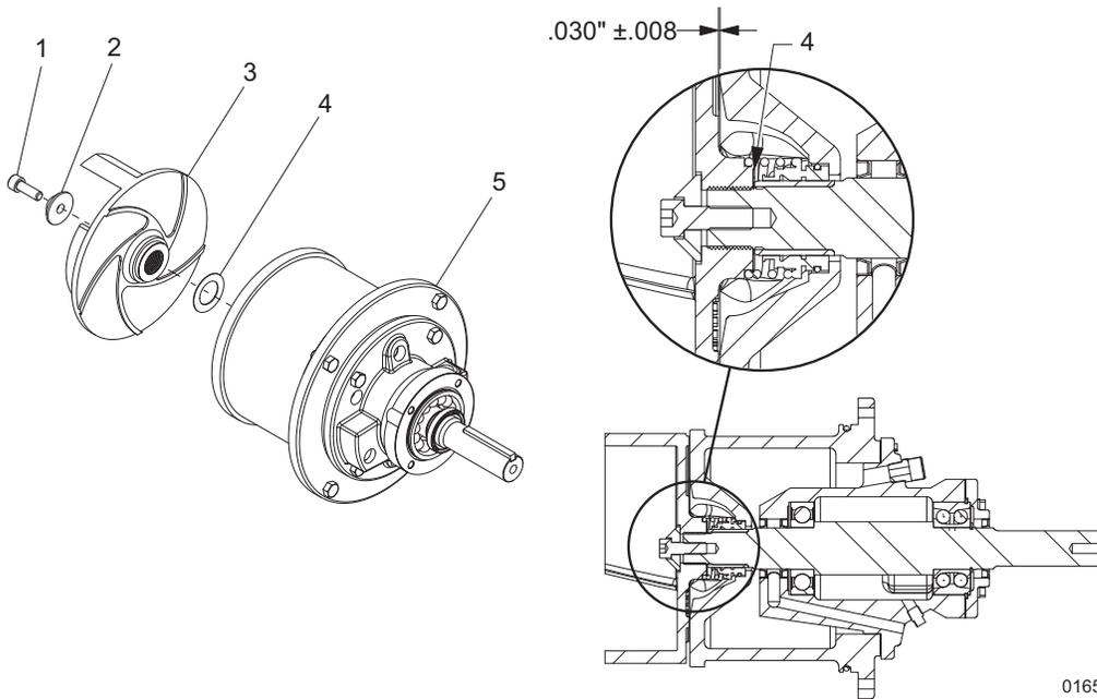
**Figure 4-8. Impeller Components**
